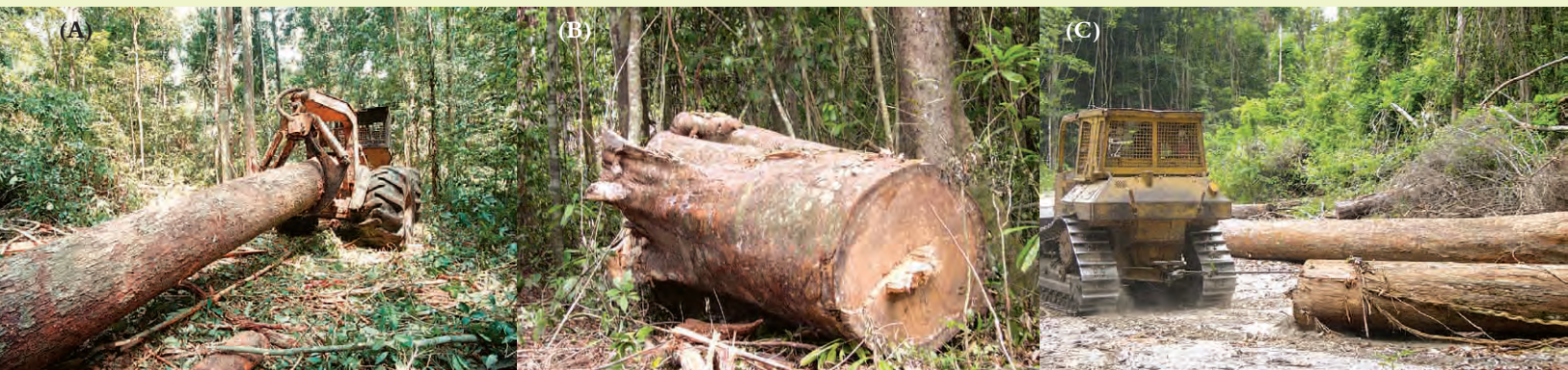
Figura 5. Avaliação dos verificadores do módulo técnico do manejo florestal. (A) Operação de arraste florestal com trator skidder; (B) Avaliação de desperdícios de madeira durante as operações; (C) Operação de arraste florestal com trator de esteiras.
