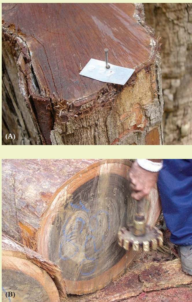
Figura 8. Avaliação dos verificadores do módulo de cadeia da custódia do Samflor. (A) Identificação dos tocos de árvores exploradas; (B) Sistema de marcação de toras no pátio.
